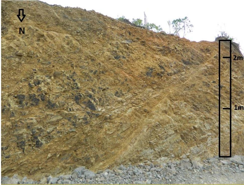
*Ilustración 8.* Fotografía que muestra la intensidad del fracturamiento y algunos posibles planos de fallas locales, evidenciando también que no se logra definir un plano de estratificación.
