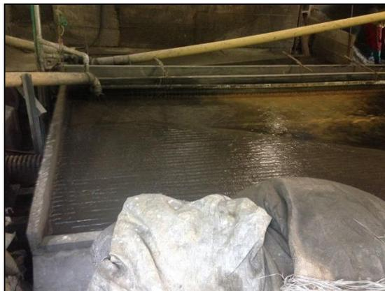
Separación del material remolido por densidades en la mesa concentradora.
